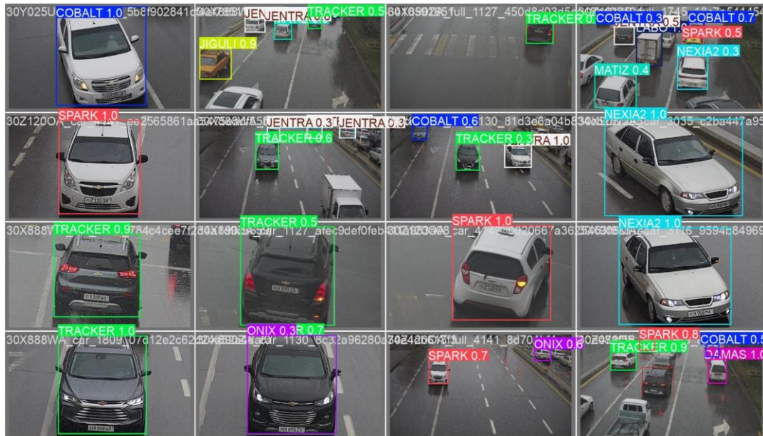
Рис. 6. Детекции на трассе во время дождя: мокрый асфальт, блики, разные масштабы/ракурсы и перекрытия; модель стабильно распознаёт автомобили.
